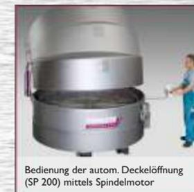
Bedienung der autom. Deckelöffnung (SP 200) mittels Spindelmotor
