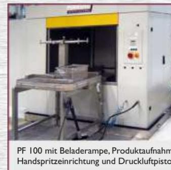
PF 100 mit Beladerampe, Produktaufnahme, Handspritzleinrichtung und Druckluftpistole
