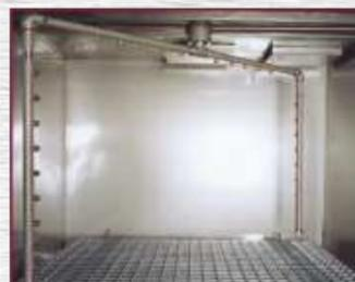
(Standard) Rotierendes Düsenrohrsystem
