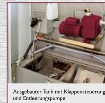
Ausgebauter Tank mit Klappensteuerung und Entleerungspumpe
