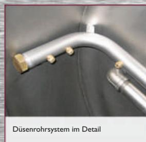
Düsenrohrsystem im Detail
