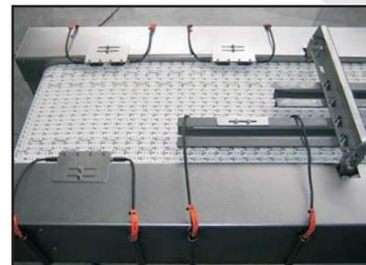
Beispiel: Transportband mit Produktführung und Bauteilabfrage
