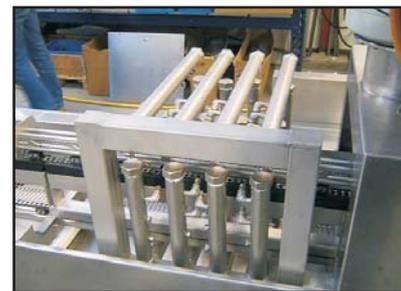
Beispiel: Düsenrohrsystem mit einstellbaren Flachstrahldüsen
