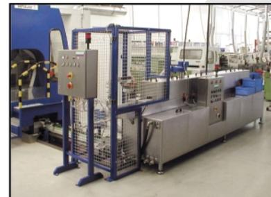
Clean-o-mat TW 102 inkl. Lineargreifeinheit zur Produktzuführung
