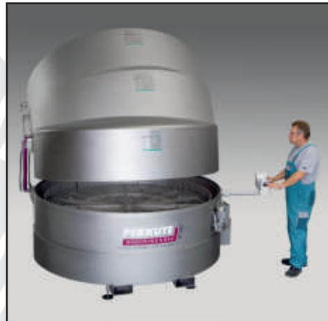
Bedienung der hydraulischen Deckelöffnung
